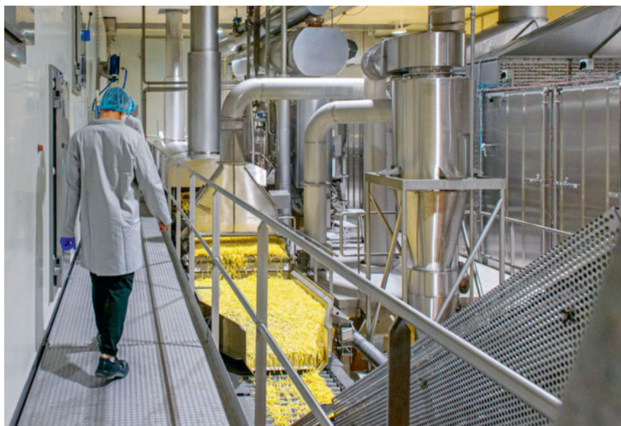
Aperçu de la production de pommes frites à Cressier (NE). Les bâtonnets qui sortent de la friteuse sont acheminés vers la cellule de congélation rapide. Photo: Manuela Eberhard
