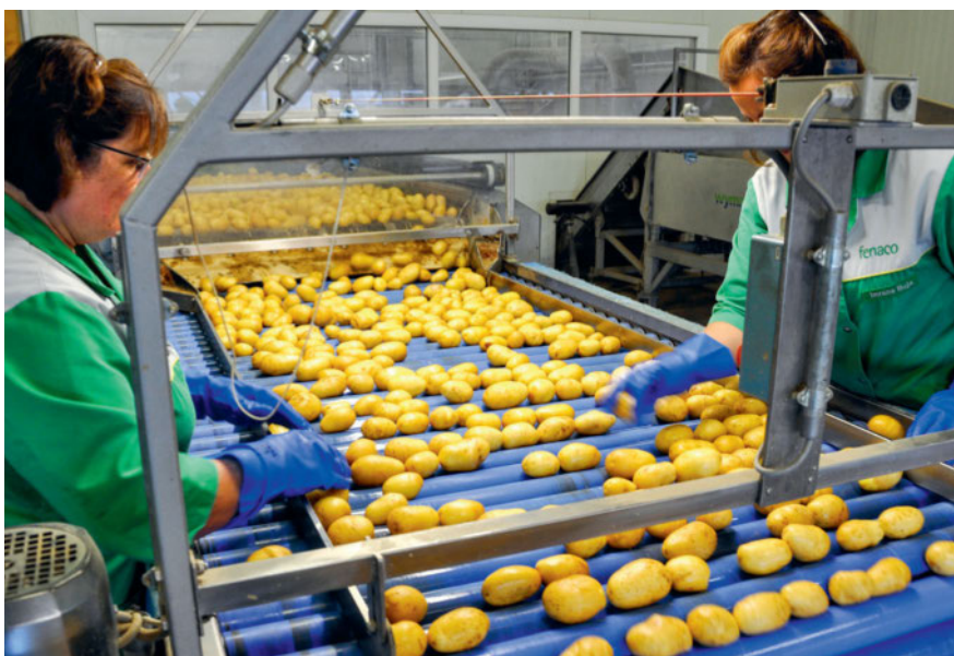
Après le calibrage et le lavage, les pommes de terre sont contrôlées sur le tapis de tri.
