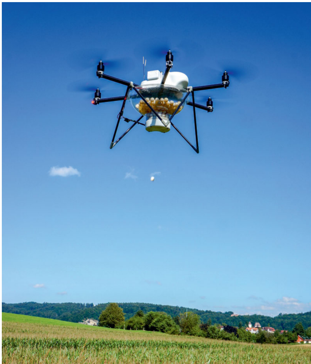
Drone utilisé pour la lutte biologique contre les ravageurs en lançant des trichogrammes.
