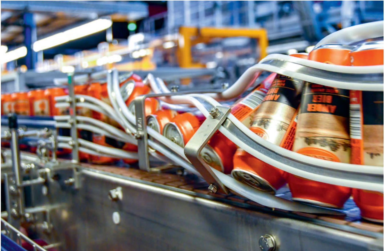
Au cours du processus de remplissage, les canettes sont retournées à plusieurs reprises.
